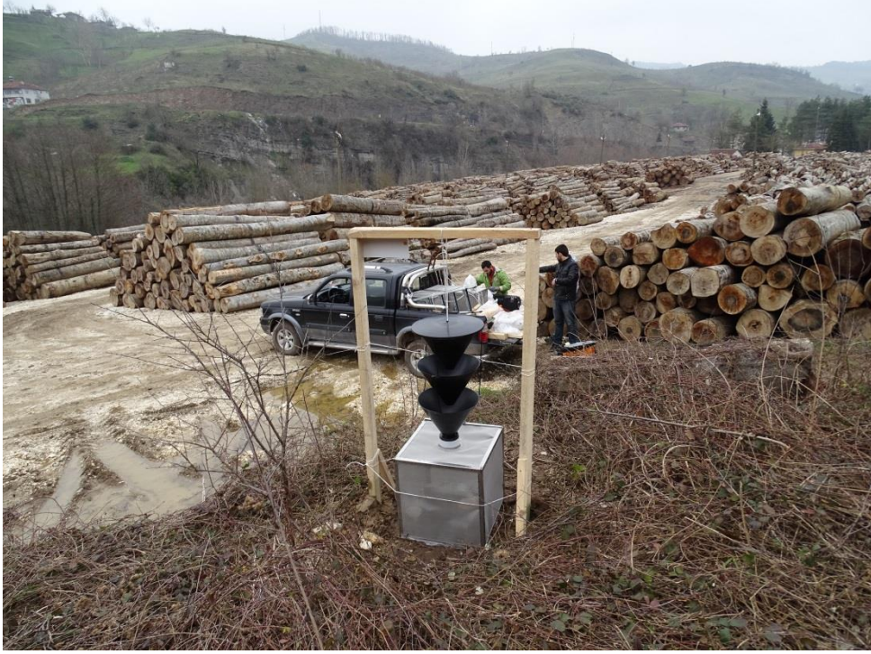
Şekil 2. Yeni geliştirilen böcek toplama kafes sisteminin kurulması
