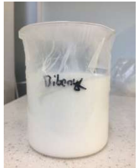
Şekil 2. Biberiye esansiyel yağı kullanılarak oluşturulan nanoemülsiyon
