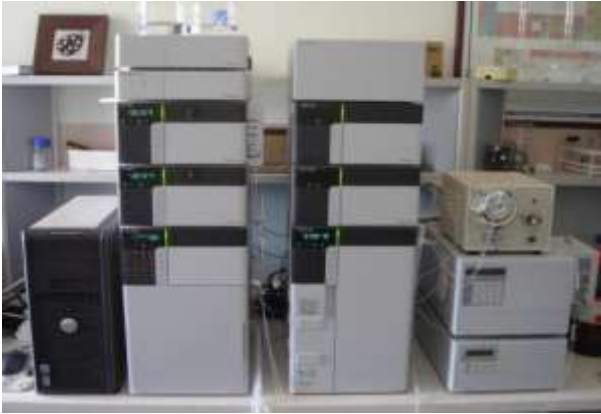
Şekil 3. Biyojen amin analizi için kullanılan HPLC cihazı
