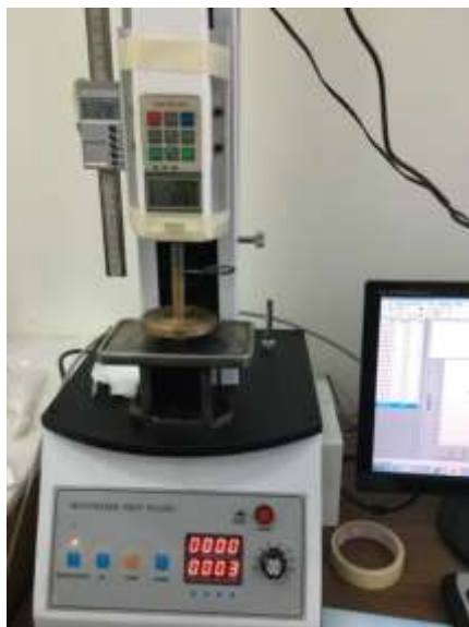
Şekil 1. Biyolojik malzeme test cihazı ve beyaz mersin meyvesinin aksel boyutları ( X , Y ) ile aksel kuvvetlerin ( F_x ve F_y ) gösterimi.
