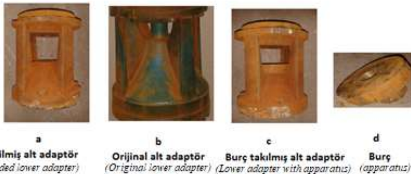
Şekil 4 Pompaların alt adaptörleri ve giriş ağız kesit alanı değiştirme burcu Figure 4. The pump bottom adapters and inlet cross-sectional area replacement apparatus
