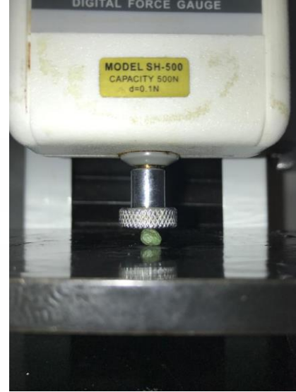
Şekil 3. Menengiç meyvesine ait üç ( a , b , c ) eksenel boyuta ait kuvvetlerin ( F_a , F_b , F_c ) gösterimi ve test ölçümü
