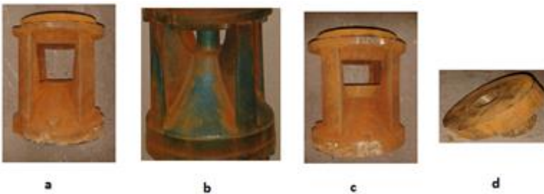
Şekil 3 M 1 pompasına ait farklı giriş ağız kesit alanları (a: %20 büyütülmüş, b: orijinal, c: %20 küçültülmüş) ve değiştirme burcu (d) Figure 4. Different inlet cross-sectional areas (a: 20% magnified, b: original, c: 20% reduced) and replacement device of the M1 pump
