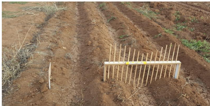
Figure 3. Rillmeter used in measuring the flow cross-sectional areas Şekil 3. Akış kesit alanlarının ölçülmesinde kullanılan rillmeter
