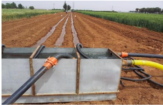
Figure 2. Orifice used to provide a constant water head Şekil 2. Sabit su yükü sağlamak için kullanılan orifis
