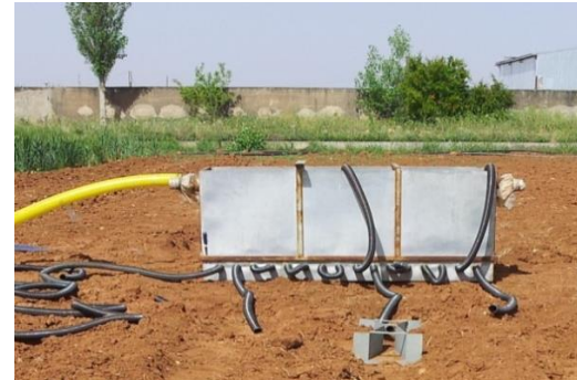
Figure 2. Orifice used to provide a constant water head Şekil 2. Sabit su yükü sağlamak için kullanılan orifis
