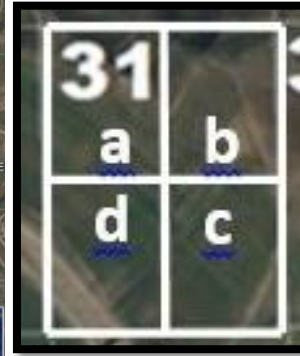
Şekil 4. KSÜ Avşar yerleşkesi enlem ve boylam derecelerine göre oluşturulmuş karelej sistemi ve saat işleyişi yönünde harflendirilmiş tek bir karelej
